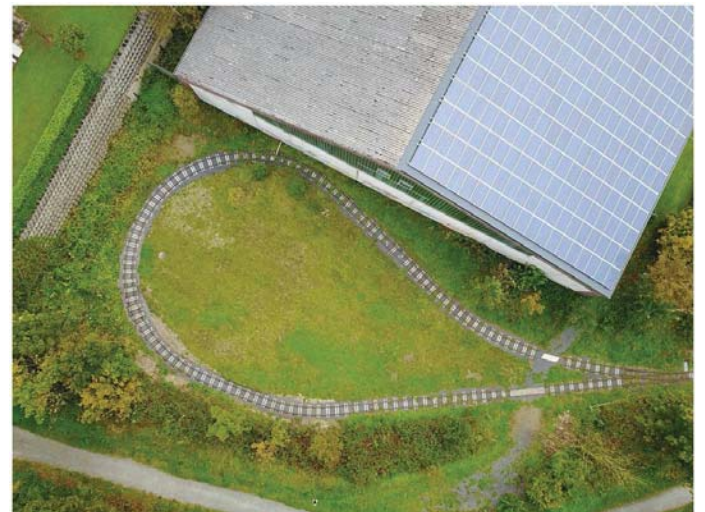
Das Ergebnis unserer Bemühungen aus der Vogelperspektive unseres Drohnen-Piloten. Die Kehrschleife passt sich eng den Platzverhältnissen an. Rechts erkennt man die beiden Bahnübergänge zur Tennishalle. Foto: Christian Gasterstädt
